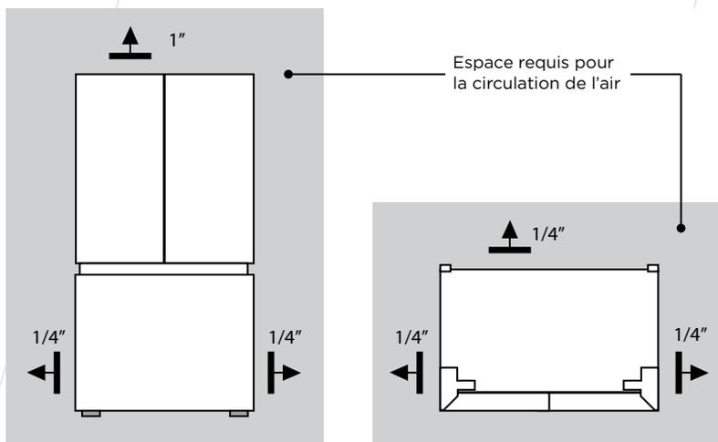
Le réfrigérateur doit être placé dans un endroit sec et bien ventilé avec un dégagement minimum de 1/4" à l'arrière et sur les côtés et 1" au-dessus.
