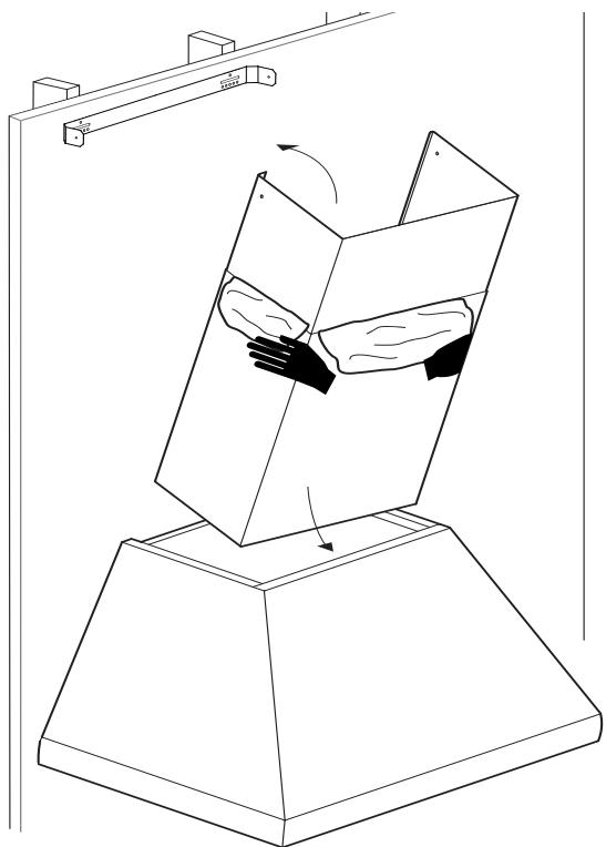
7. À partir de l'intérieur, vissez à travers les trous latéraux et avant les vis à tôle de 5/8 po (16 mm) fournies dans le bas de la rallonge. La quantité de vis fournies dépend des dimensions de la hotte.
