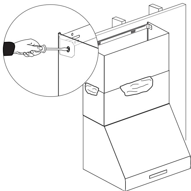
5. Montar la placa de fijación en las ubicaciones de los largueros de la pared y ancla de la pared utilizando tornillos de 1/2" (13 mm), (incluidos). Asegurarse de que la placa de fijación está nivelada.
