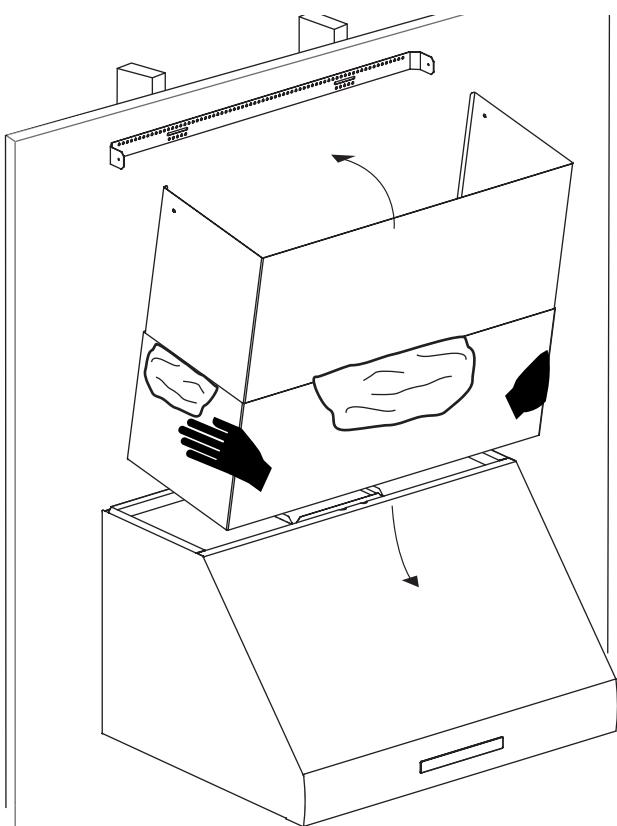
7. A partir del interior de la campana, atornille los tornillos para chapa de 5/8 pulg. (16 mm) proporcionados a través de los agujeros de cada lado y de la parte delantera del alargador. La cantidad de tornillos depende del tamaño de la campana.
