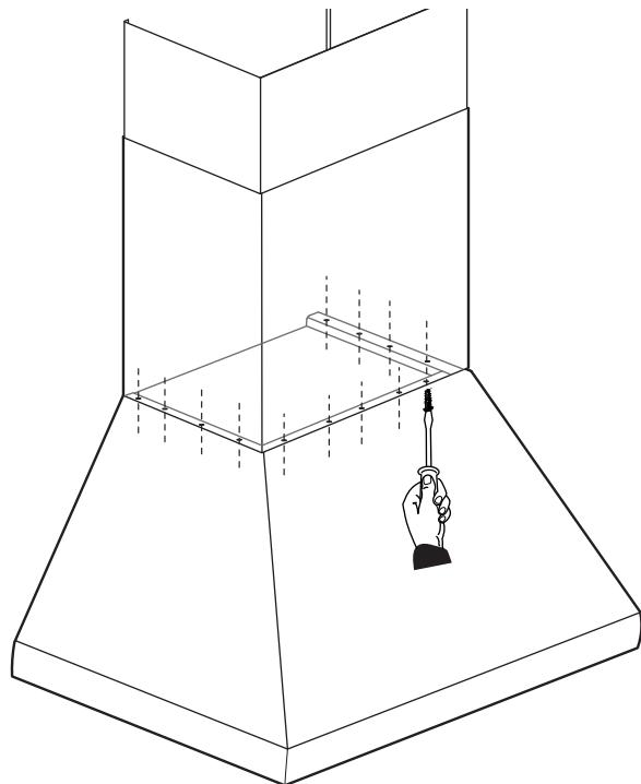
6. Empuje cuidadosamente la parte superior del alargador hacia arriba. Atornille los lados izquierdo y derecho del alargador al soporte de montaje con los tornillos para acero inoxidable proporcionados.
