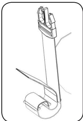
**Passez la courroie dans les fentes de la tablette inférieure et attachez-la sur le dessus de la bonbonne, comme illustré.**
