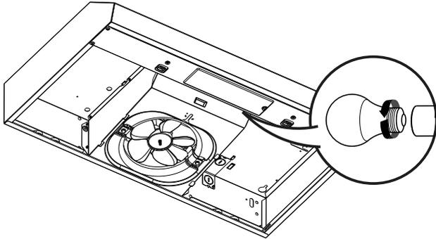
4. Installer une ampoule DEL de 9 watts maximum, 120 V, à culot E26.
