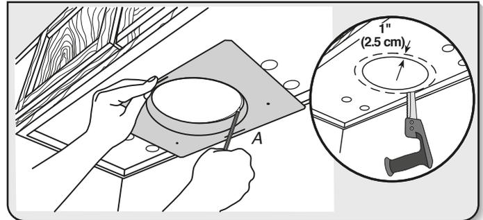
■ À l'aide de la plaque de montage du conduit circulaire de 7" (17,8 cm), marquer le tracé de l'ouverture d'évacuation sur la face inférieure du placard :
