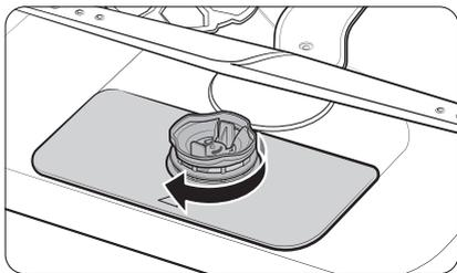
4. Retirez toute la saleté et les impuretés au niveau du microfiltre et du pré-filtre.
