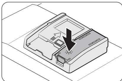
3. Fermez le couvercle du réservoir de produit de rinçage.
