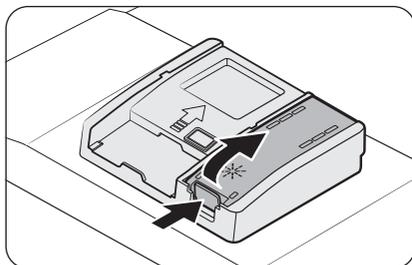
1. Ouvrez le couvercle du réservoir de produit de rinçage.
