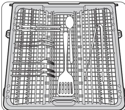
Le 3e panier est mieux adapté pour la vaisselle plate ou les ustensiles de cuisson et de service. Utilisez-le avec le support à couverts dans le panier inférieur. Vous pouvez placer les couverts et ustensiles dans le 3ème panier ou le support à couverts dans le panier inférieur.
