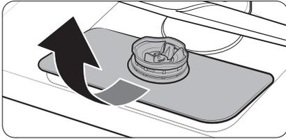
3. Retirez le pré-filtre, puis le microfiltre cylindrique en-dessous.
