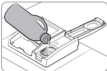
2. Remplissez le réservoir avec du produit de rinçage.
