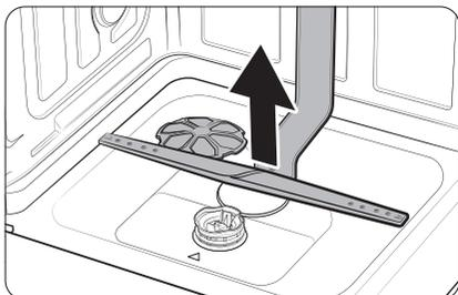
1. Ouvrez la porte et tirez le panier inférieur pour le retirer. Le gicleur inférieur est visible au fond.
