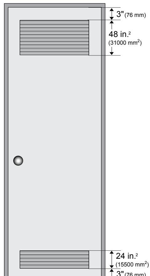
**REMARQUE :** Le devant du placard doit avoir deux bouches d'air non obstruées d'une surface totale combinée d'au moins 72 po<sup>2</sup> (465 cm<sup>2</sup>) et un dégagement minimal de 3 po (76 mm) au haut et au bas. Une porte à lattes avec un dégagement équivalent est acceptable.
