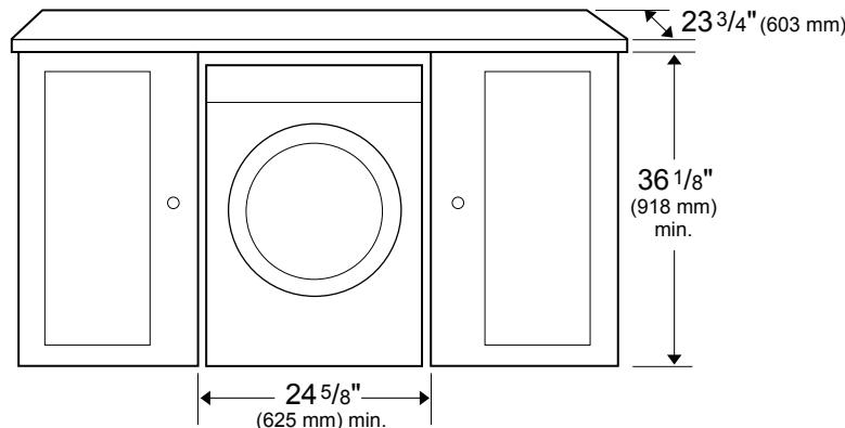
Dégagement minimal requis (installation autonome, côté à côté ou superposée) :
