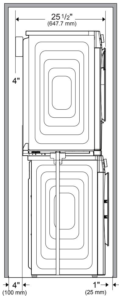
**REMARQUE :** L'espace de dégagement de 4 pouces requis doit être mesuré à partir de l'arrière de l'armoire de la sécheuse, et NON à partir de la boîte de jonction située en haut, à l'arrière de la sécheuse.
