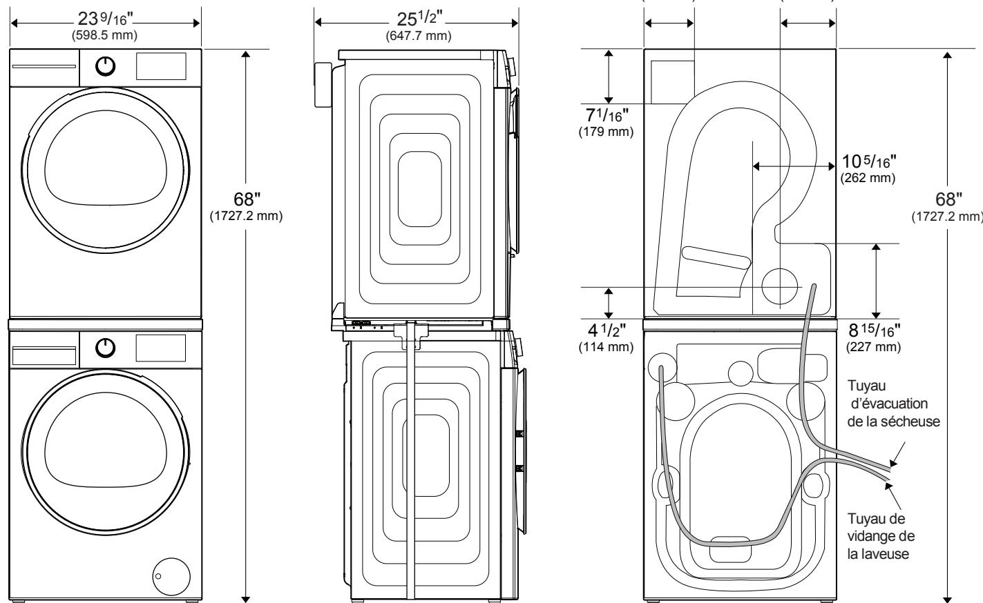
REMARQUE : Une seule prise électrique est requise puisque la laveuse peut être branchée sur la sécheuse, mais deux prises électriques peuvent être utilisées.
