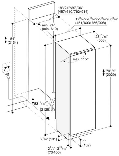
Les dimensions maximales de l'avant de la porte sont basées sur un écart de 1mm.
