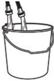
Deje correr el agua durante unos segundos a través de las mangueras en una bañera de lavandería, un desagote o un cubo para evitar atascos. El agua debe correr hasta que salga limpia.
