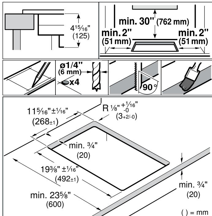
**Combinación de distintos aparatos Vario:** Tener en cuenta la necesidad de contar con espacio adicional para la junta de unión VV 200 a la hora de crear el hueco. Los aparatos también se pueden instalar en huecos individuales si se mantiene un espacio mínimo de 1½" (40 mm) entre ellos.
