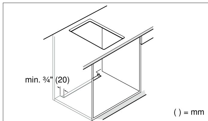
**Nota:** Si el aparato se instala en una unidad de isla u otra instalación que no se describe aquí, se deberá comprobar que la placa de cocción esté suficientemente ventilada.
