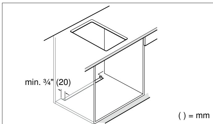
**Remarque :** Si l'appareil électroménager est installé dans un îlot ou un autre type d'installation qui n'est pas décrit dans le présent document, vous devez vous assurer que la table de cuisson est dotée d'une ventilation suffisante.
