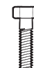
Tirafondo o perno de expansión con camisa de ½ pulgada (diámetro exterior)
