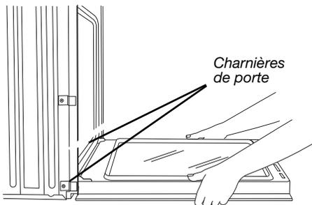
3. Identifier les loquets de charnière de la porte du four dans les deux angles de la porte; faire pivoter les loquets de charnière vers la porte du four jusqu'à la position de déverrouillage. Si le loquet de charnière de porte n'est pas complètement tourné (voir illustration B), la porte ne se retirera pas correctement.
