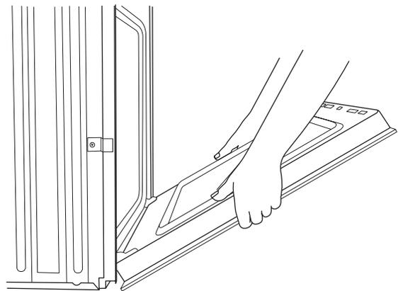
5. Saisir les bords de la porte du four avec les 2 mains. Fermer la porte du four légèrement dépassé la position d'arrêt pour réduire la charge supportée par les loquets, puis tirer la porte de four vers le haut.
