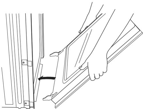
4. S'assurer que les encoches de charnière de la porte sont engagées au fond des fentes de la cavité du four.
