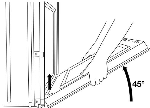
6. Tirer la porte du four vers soi et enlever la porte. Si nécessaire, basculer doucement la porte d'un côté et de l'autre en la tirant.
