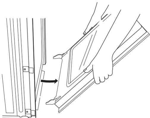
7. Conserver la/les porte(s) du four à part sur la surface de travail couverte en faisant reposer la porte sur sa poignée.
