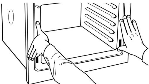
3. Pousser complètement le four dans le placard et le centrer dans la cavité d'encastrement du placard.
