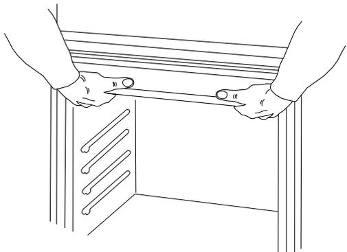
2. Pousser contre le châssis avant du four à micro-ondes pour introduire le four dans le placard.
