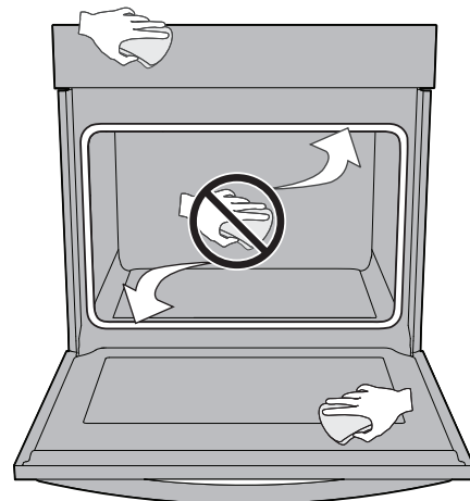
Figure 18: Nettoyer le pourtour du joint de la porte du four
