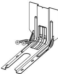
5. À l'aide des deux vis à tête cruciforme n° 10 x 1<sup>5</sup>/<sub>8</sub>" (4,1 cm) fournies, visser la bride antibasculement au mur ou au plancher.
