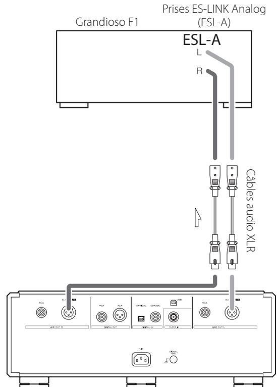
Utilisez des câbles audio XLR pour raccorder les prises de sortie audio analogique (XLR/ESL-A) de cette unité aux prises ES-LINK Analog (ESL-A) d'un Grandioso F1 ou d'un autre amplificateur.
