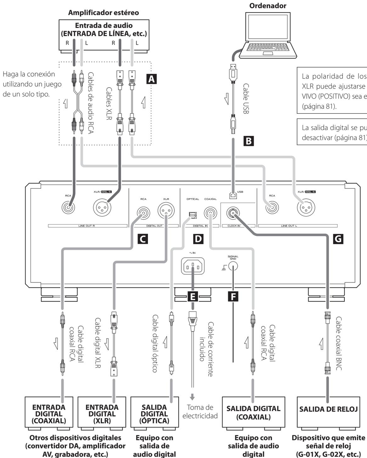
**A Terminales de salida de audio analógico (LINE OUT)**
