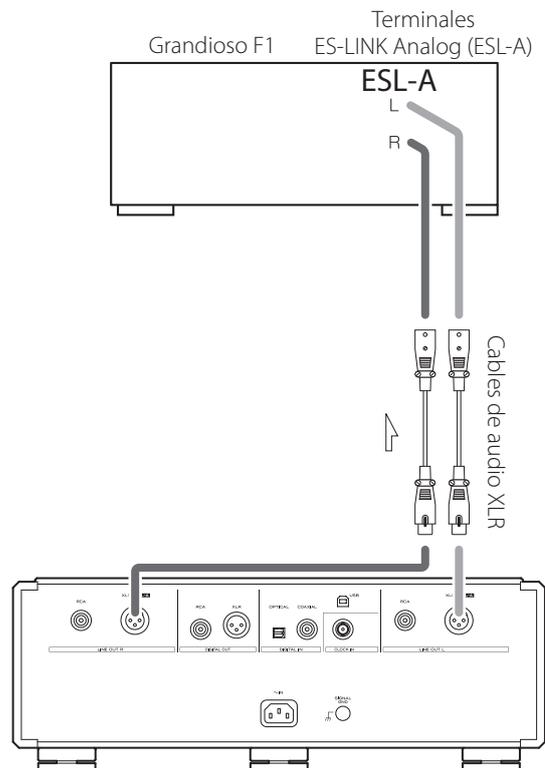
Utilice cables de audio XLR para conectar los terminales de salida de audio analógico (XLR/ESL-A) de esta unidad a un Grandioso F1 u otro amplificador que tenga terminales ES-LINK Analog (ESL-A).
