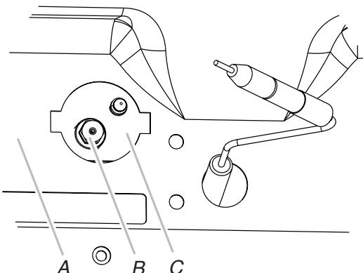
4. Chaque injecteur de gaz naturel est marqué d'une lettre et d'un numéro. Installer l'orifice du brûleur de cuisson au gril numéro 148.
