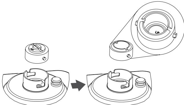
6. Serrer le chapeau du détendeur à l'aide d'un gros tournevis à lame plate en tournant le chapeau du détendeur dans le sens horaire.
