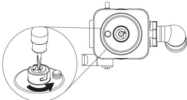
5. Retourner le capuchon du détendeur et le réinstaller sur le régulateur pour que l'embout vide fasse face vers l'extérieur et que les lettres « LP » soient visibles.
