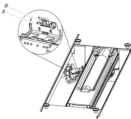
A. Support de l'électrode du brûleur de cuisson au four
