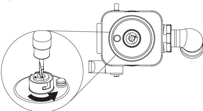
5. Retourner le capuchon du détendeur et le réinstaller sur le régulateur pour que l'embout vide fasse face vers l'intérieur et que les lettres « NAT » soient visibles.
