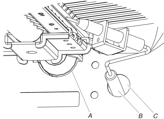
7. Réinstaller la vis du brûleur de cuisson au gril du four. Voir l'étape 1 pour l'illustration. La vis est alignée avec l'orifice, lorsqu'un clic se fait entendre.
