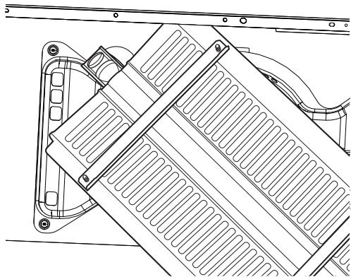
3. Appliquer du ruban adhésif de masquage à l'extrémité d'un tourne-écrou de 1/4 po (6,4 mm) pour retenir l'injecteur du brûleur dans le tourne-écrou durant l'extraction. Insérer le tourne-écrou dans l'ouverture de gaz, appuyer sur le gicleur de gaz propane et le retirer en le faisant tourner dans le sens antihoraire et en le soulevant. Conserver le gicleur pour propane pour plus tard.
