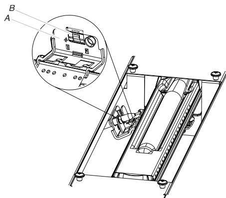
A. Support de l'électrode du brûleur de cuisson au four
