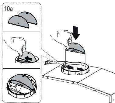
Installez les volets de clapet (10a) inclus avec la hotte en mettant les languettes en place à l'intérieur du haut de la hotte avant de raccorder les conduits.
