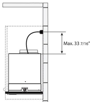
**AVERTISSEMENT** - « Le cordon d'alimentation doit être accessible pour inspection après l'installation ».
