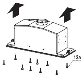
Insérez la hotte jusqu'à ce que les supports latéraux s'enclenchent en place. Fixez à l'aide des 10 vis **12a** fournies.
