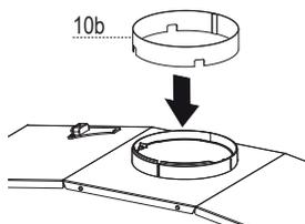
Installez l'anneau métallique du clapet (10b) fourni avec la hotte.
