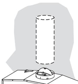
Installez le capuchon de toit ou de mur acheté séparément. Raccordez la gaine métallique de 6 po au capuchon de toit ou de mur, puis fixez la gaine. Scellez avec du ruban adhésif.
