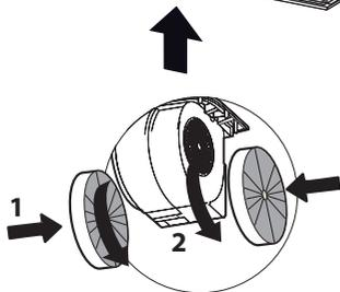
Fixez les filtres à charbon à la grille noire de chaque côté du ventilateur. Pressez fermement le filtre à charbon contre la grille noire de chaque côté du ventilateur et faites tourner le filtre dans le sens des aiguilles d'une montre (vers l'avant de la hotte encastrable) jusqu'à ce qu'il soit verrouillé en place. Faites tourner dans le sens contraire des aiguilles d'une montre (vers l'arrière de la hotte encastrable) pour l'enlever.
