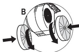
**Attention :** « Lorsqu'il est utilisé en mode recirculation, pour réduire le risque d'incendie et de choc, utilisez uniquement le kit de conversion Modèle de filtre à charbon sku #901531 ; Kit de filtre à charbon durable sku #901532 ».
