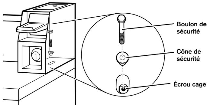
**NOTE :** L'installation du boulon de sécurité offre une sécurité supplémentaire, mais représente aussi un délai supplémentaire pour une réparation éventuelle, lorsqu'il faut retirer le dessus pour réparer la sècheuse.
