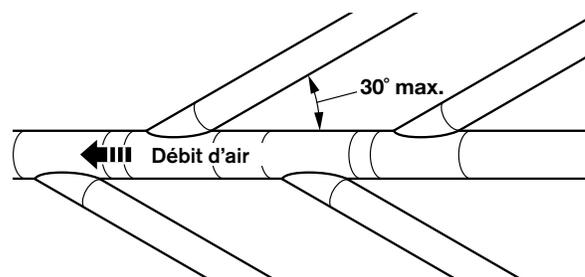
L'inclinaison maximale de chaque conduit qui pénètre dans le conduit principal ne doit pas dépasser 30°.
