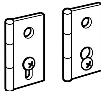
12. Fermer la porte et vérifier que la gâche de la porte est alignée avec le loquet. Au besoin, faire glisser le loquet de la porte vers la gauche ou vers la droite à l'intérieur de l'encoche pour régler l'alignement.
