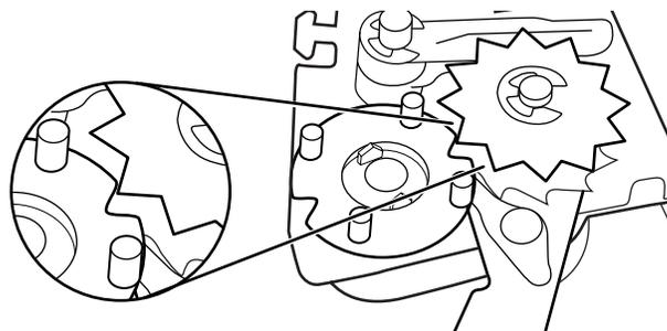
7. Appuyer sur la came pour la mettre en place sur l'axe du moteur; veiller à ce que l'encoche en V laisse passer la dent de la roue dentée.
