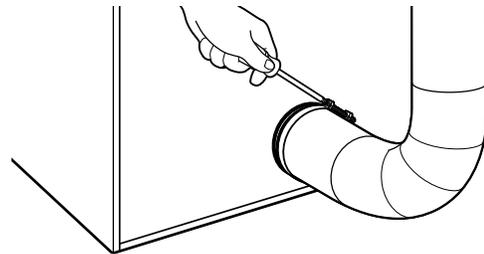
4. S'assurer que le conduit d'évacuation est fixé au clapet d'évacuation à l'aide d'une bride de fixation de 4" (102 mm).
