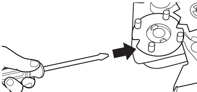
5. Placer la nouvelle came (moyeu vers le bas) sur l'axe. Aligner le méplat de l'axe avec le méplat du trou de la came. Veiller à mettre en place l'onglet d'entraînement.
