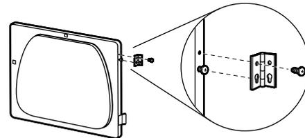
10. Ôter les 4 vis fixant les 2 bouchons d'obturation du côté de la poignée. Fixer les bouchons d'obturation au côté opposé à l'aide des mêmes 4 vis.
