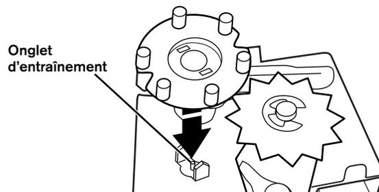
6. Faire tourner la came pour aligner l'encoche en V sous la dent de la roue dentée.
