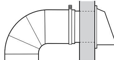
5. Placer la sècheuse à son emplacement final. Ne pas écraser ni pincer le conduit d'évacuation. Vérifier que la sècheuse est d'aplomb.
