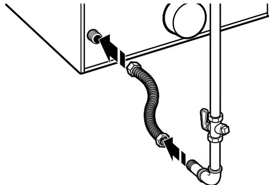
**REMARQUE :** Ne pas déformer/endommager la canalisation en acier inoxydable flexible lors du déplacement de la sècheuse.
