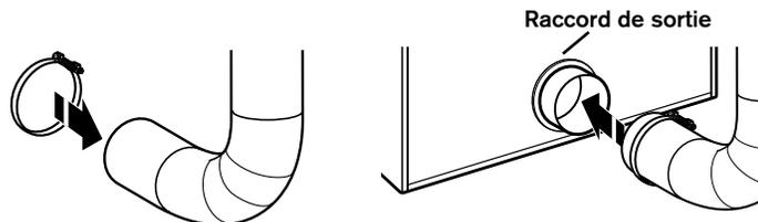
3. Serrer la bride de serrage de tuyau avec un tournevis Phillips.
