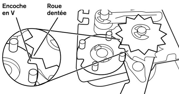
4. Insérer un tournevis à lame plate étroite sous la came de minutage, près de l'axe. Soulever doucement la came verticalement pour la séparer de l'axe; veiller à ce que l'encoche en V laisse passer la dent de la roue dentée.
