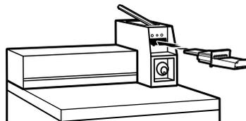
Pour une sècheuse dotée d'un mécanisme d'insertion à glissière, utiliser l'ensemble d'adaptation fourni avec la sècheuse.
