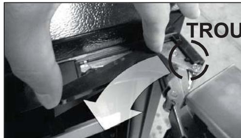
2. Mettez la porte à moins de 90° afin que le mécanisme de la charnière n'obstrue pas le trou et insérez le butoir de porte dans le trou.
