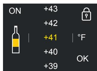
Si se toca el icono de función y se ajusta una función específica, el candado amarillo aparecerá cerrado y no será posible cambiar la temperatura de los compartimentos mientras no se complete la función o si se desactiva manualmente mientras la función esté activa.
