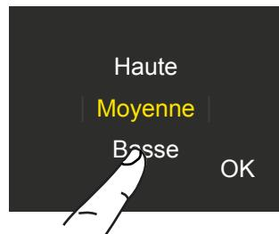
**C)** Défilez pour sélectionner l'humidité désirée et pressez ok.
