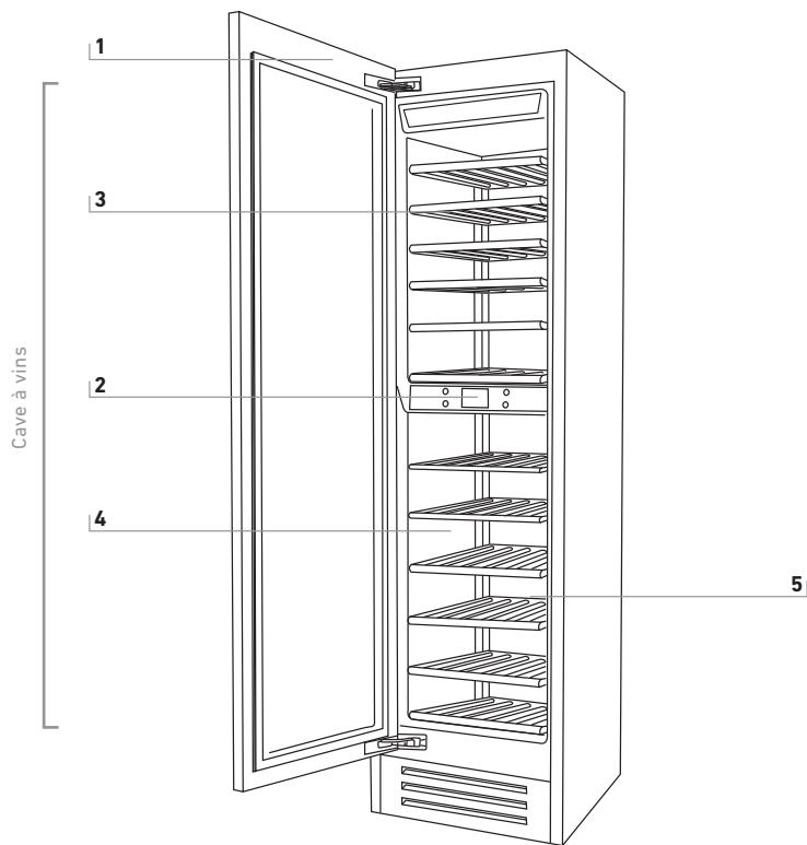
**1)** Structure en acier inox avec finitions en aluminium.
