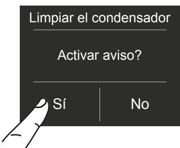
Si desea desactivar el recordatorio, en el paso C pulse Off, y luego pulse Sí.
