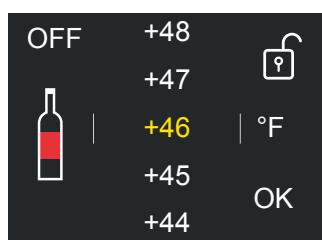
Alors qu'un cadenas fermé est affiché si l'utilisateur a activé quelques fonctions qui modifient les configurations du compartiments, par conséquent l'utilisateur dans cette condition ne sera plus en mesure de modifier la température des compartiments.
