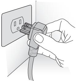
El aparato funciona a 115 VCA, 60 Hz y está equipado con un cable de alimentación con una clavija de 3 polos con conexión a tierra, que debe enchufarse en una toma de corriente correspondiente de 3 polos (15 Amp) con conexión a tierra situada en la pared.
