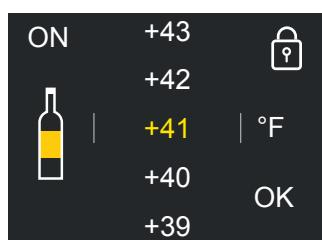
En cas de pression de l'icône fonction et d'activation d'une fonction spécifique (par exemple, vacances, shopping, etc.), le cadenas jaune apparaît fermé et il ne sera pas possible de modifier la température des compartiments tant que la fonction activée n'est pas terminée ou si elle est désactivée manuellement.
