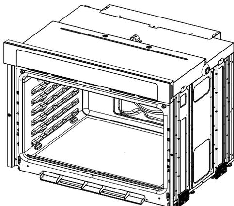
**La hauteur de la cavité d'encastrement est comprise entre  $26\frac{15}{16}$ " et  $27\frac{1}{16}$ " (68,4 cm et 70,3 cm)**
