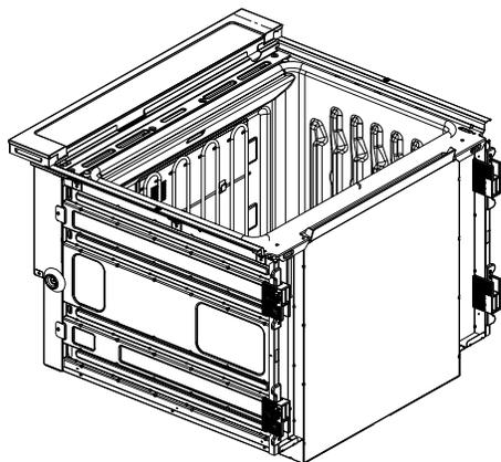
2. Retirer le pied de la cale d'espacement avant droite en ôtant la vis n° 8-18 x  $\frac{3}{8}$ ".
