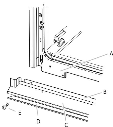
A. Châssis du four      D. Garniture de l'évent inférieur
