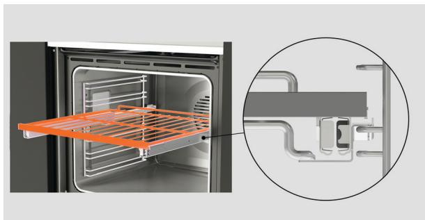
2. Pour remettre l'étagère en place, placez-la sur les supports latéraux et poussez-la dans le four, avec la barre de retenue à l'arrière.
