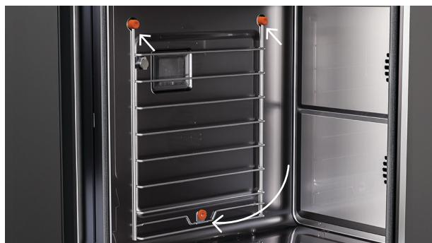
3. Pour la remettre en place, insérez le dessus de la grille dans les montants, puis poussez la base de la grille jusqu'à ce qu'elle soit à niveau contre le côté du four. Refixez l'écrou à la base de la grille et serrez-le fermement.
