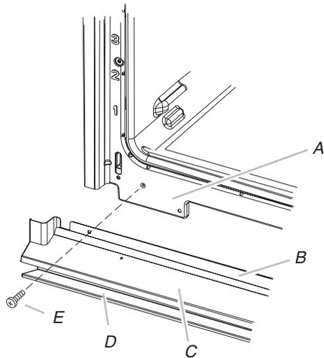
A. Châssis du four      D. Support du déflecteur
