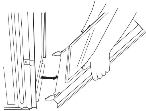
6. Conserver la/les porte(s) du four à part sur la surface de travail couverte en faisant reposer la porte sur sa poignée.
