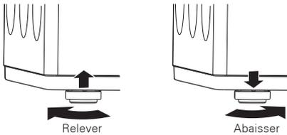
2. Ajustez pieds de mise à niveau. Faites-les pivoter dans le sens des aiguilles d'une montre pour relever la machine, ou dans le sens inverse pour l'abaisser.
