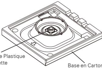
2. Garder le bloc de polystyrène extrudé (qui contient de Guide d'Utilisateur, les pièces et les échantillons de produit de lessive) pour une utilisation ultérieure. Si la machine à laver doit être bougée dans le futur, cette mesure contribuera à prévenir les dommages lors du transport.
