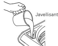
Le distributeur à javellisant dilue et distribue automatiquement le javellisant au moment approprié durant le cycle de lavage.
