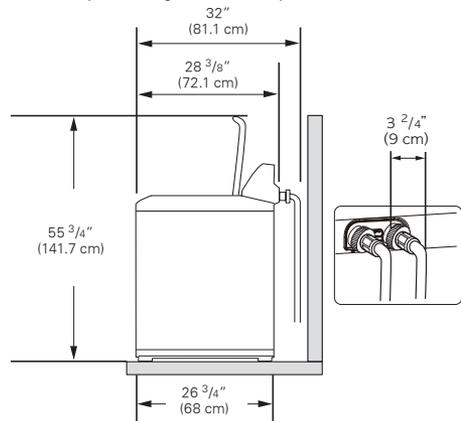
L'espace minimum vertical à partir du plancher jusqu'aux tablettes, la cabinetterie, les plafonds, etc., est de 56 pouces.
