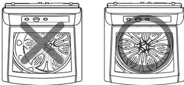
3. Pour vous assurer que la machine à laver est à niveau, ouvrez le couvercle et regardez si la cuvette est centrée. Si la cuvette N'EST PAS centrée (comme le démontre le dessin doté d'un X), réajustez les pieds de devant. Si vous avez un niveau de charpentier, utilisez-le pour mettre la machine à laver à niveau.
