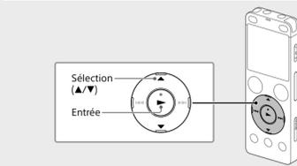
À la première mise sous tension de l'enregistreur IC, le message « Configure Initial Settings » s'affiche à l'écran. Vous pouvez alors sélectionner la langue affichée, régler l'horloge, et activer ou désactiver le bip.
