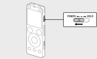
Faites glisser et maintenez le commutateur POWER+HOLD vers « POWER » jusqu'à ce que la fenêtre s'affiche. Pour la mise hors tension, faites glisser le commutateur POWER+HOLD vers « POWER » et maintenez-le jusqu'à ce que « Power Off » s'affiche à l'écran.
