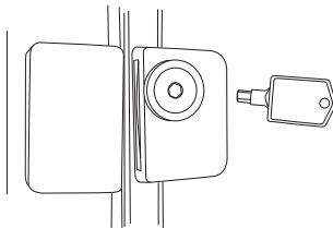
La llave del bloqueo activado por resorte es eyectado de forma automática; la llave no permanecerá en el bloqueo ya sea en la posición abierta o cerrada.
