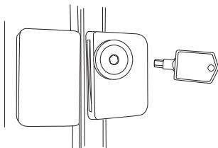
La serrure à ressort assure l'éjection automatique de la clé—celle-ci ne restera pas dans la serrure en position verrouillée ou déverrouillée.
