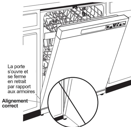
Un alignement incorrect causera des dommages à la porte. La porte est appuyée contre le devant des armoires.
