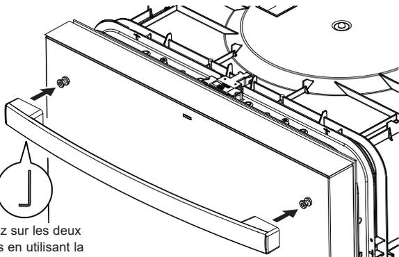
Fixez sur les deux côtés en utilisant la clé Allen de 1/8 po
