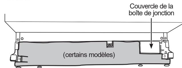
Le matériau illustrée correctement placée le long au bord inférieur de la boîte de commande, le de la partie inférieure du lave-vaisselle et affleurant la face avant.
