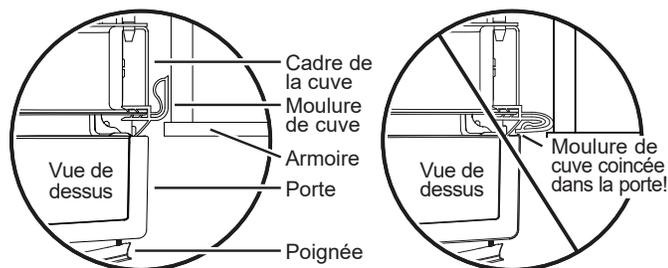
Si nécessaire, la moulure de cuve peut être rognée pour assurer le bon fonctionnement de la porte
