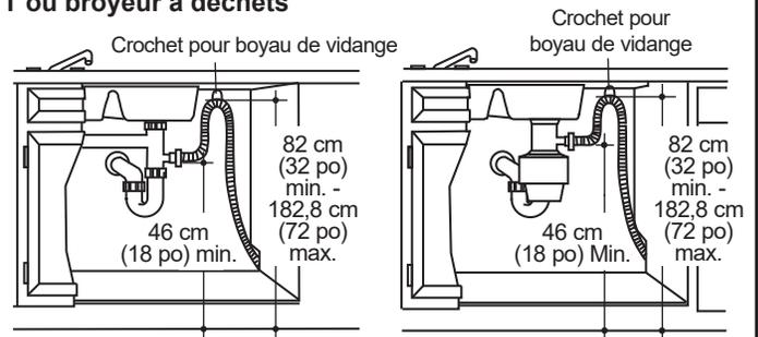
**Conseil: Pour éviter des frais de réparation inutiles.** Assurez-vous d'enlever le bouchon de vidange du broyeur à déchets avant d'y brancher le boyau de vidange du lave-vaisselle.
