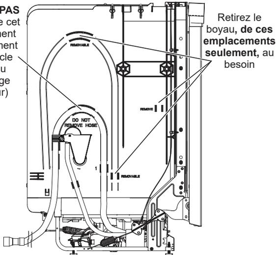
L'extrémité moulée du boyau de vidange est conçue pour s'installer sur l'orifice d'entrée d'un diamètre variant entre 15,8 mm (5/8 po) et 25,4 mm (1 po) de la coupure anti-refoulement, du raccord en T ou du broyeur à déchets.
