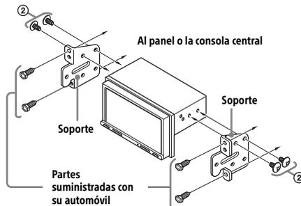
Al montar esta unidad en los soportes preinstalados de su automóvil, use los tornillos ② en los espacios para tornillos correspondientes según su automóvil:
