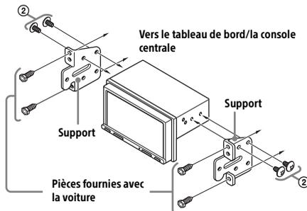
Si vous installez cet appareil sur les supports préinstallés de votre véhicule, faites passer les vis de montage ② par les trous de vis appropriés, en fonction de votre véhicule :
