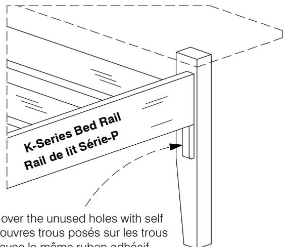
The Cover Block fixes over the unused holes with self adhesive tape. / Les couvres trous posés sur les trous non utilisés sont fixés avec le même ruban adhésif.
