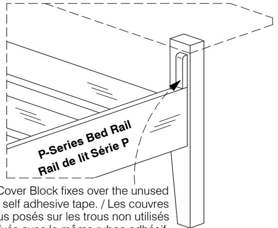
The Cover Block fixes over the unused holes with self adhesive tape. / Les couvres trous posés sur les trous non utilisés sont fixés avec le même ruban adhésif.
