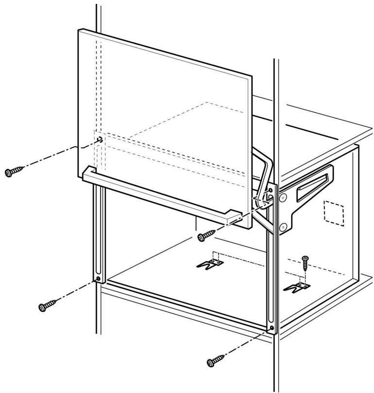
5. Facultatif : faire glisser le micro-ondes MBESLFTD de Thermador de façon à ce que les supports de fixation enclenchent les pieds de l'appareil.
