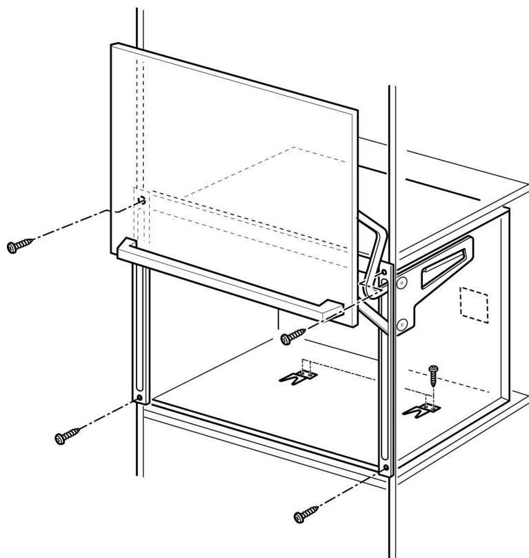
5. Opcional: Deslice el horno de microondas de Thermador MBESLFTD de manera que los soportes de fijación enganchen las patas del electrodoméstico.
