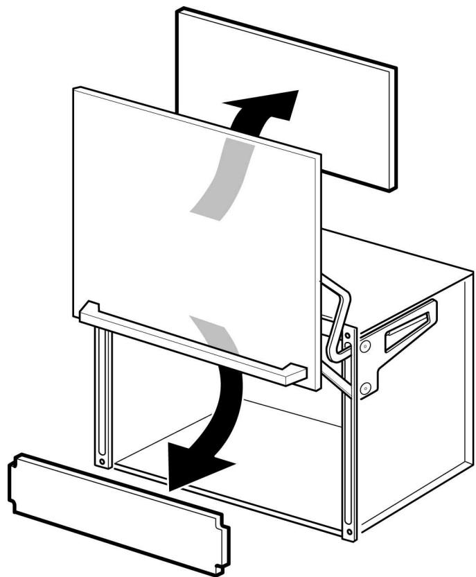
4. Monte la unidad y los soportes de fijación que se utilizarán con los 8 tornillos incluidos con la unidad.
