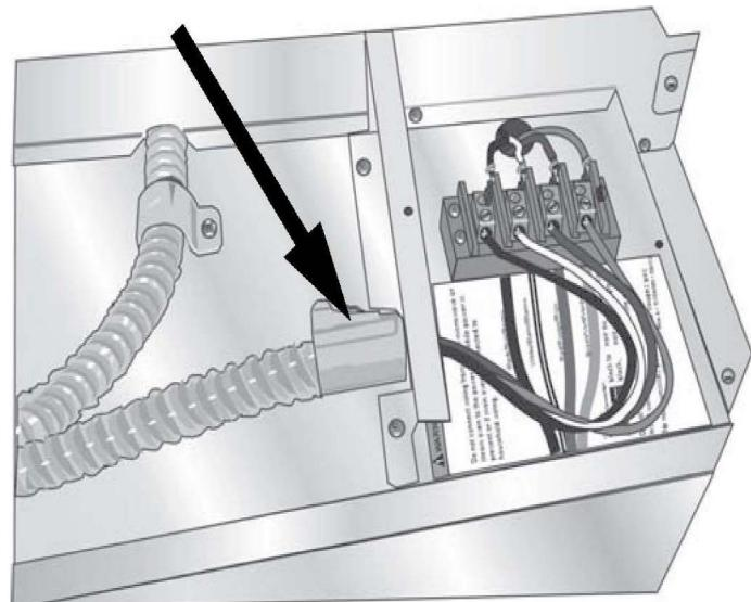
4. Colocar el conector del conducto conduit en el orificio; para ello, presionarlo hasta que se escuche un clic.
