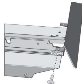
Alinear los bordes exteriores con el exterior de las guías universales. Fijar con un (1) tornillo cada uno en el orificio final de cada guía universal.
