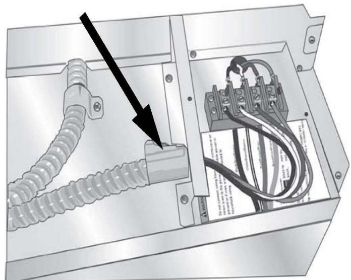
4. Encastrez le raccord de conduit dans le trou en enfonçant jusqu'à ce qu'il se mette en place avec un déclic.
