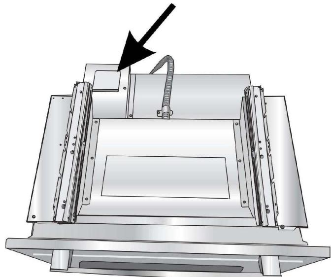
2. Quitar la cubierta del orificio de acceso del conducto en el lateral de la caja de conexiones montada en el horno.
