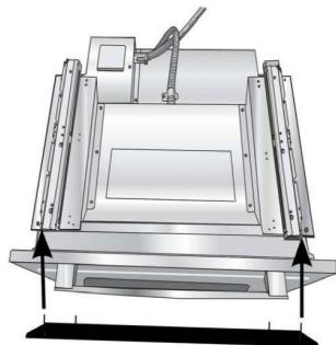
3. Colocar la unidad del horno rápido o microondas encima de las guías de conexión universales y fijarla en su sitio utilizando tres (3) tornillos en cada lado. Apretar el tornillo firmemente pero sin sobrepasarse.
