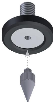
Осторожно переверните колонку в вертикальное положение. Установите каждую из АС на абсолютно ровной поверхности. При наличии неровности немного выкрутите соответствующую опору и попробуйте установить колонку еще раз – до тех пор, пока АС не будут стоять абсолютно ровно. Используйте стопор-ные гайки (см. рис. на стр. 115) для фиксации опоры.
