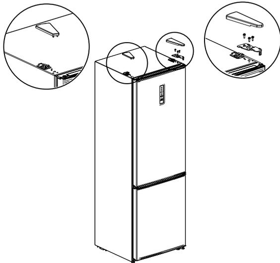
3. Démontez la charnière centrale, les vis, les bouchons des trous de vis et retirez la porte du congélateur.
