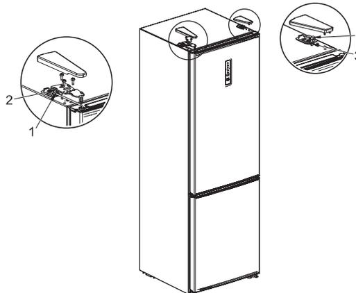
8. Installation de la poignée de porte, des précautions doivent être prises pour éviter la chute de la poignée, laquelle pourrait causer des blessures. à l'aide d'un tournevis cruciforme, fixez solidement les vis 2 dans les trous prévus à cet effet 1; couvrez les trous des vis de la poignée à l'aide 3 des capuchons fournis.
