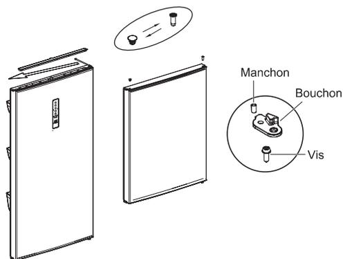
6. Placez la porte du congélateur sur la charnière inférieure, installez la charnière centrale, les vis et placez les bouchons de vis.
