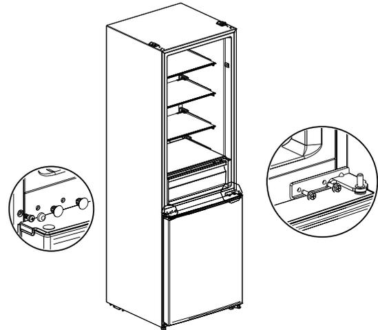
4. Retirez la charnière inférieure, les bouchons des trous et les vis, installez l'axe de la charnière inférieure de l'autre côté, puis y installez la charnière.
