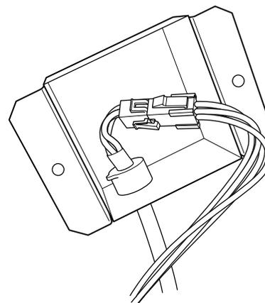
13. À l'aide d'un tourne-écrou de 1/4", visser le couvercle de raccordement électrique à la boîte des brûleurs au moyen de 2 vis.
