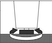
NOTE: ADJUST LEVELER IF NEEDED TO LEVEL **CABINET ON UNEVEN FLOOR.**
