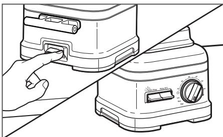
**2** L'interrupteur d'alimentation principal est situé à l'arrière du socle du mélangeur. Basculer l'interrupteur en position **I** (marche). Le témoin d'alimentation situé au dessus de l'interrupteur de marche à bascule commence à clignoter, ce qui indique que l'appareil est en mode attente. Le mélangeur est maintenant prêt à l'utilisation.
