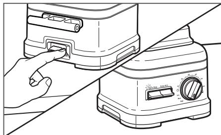
**2** El interruptor de encendido principal está en la parte posterior de la base de la licuadora. Mueva el botón **I/O** (Encendido/Apagado) a la posición **I** (Encendido). La luz indicadora de estado encima del botón alternador de arranque comenzará a parpadear para indicar que la licuadora está en modo en espera. La licuadora ya está lista para funcionar.
