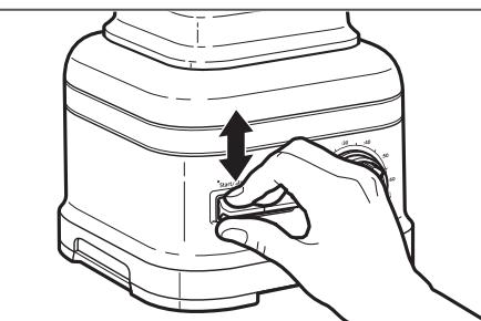
7 Après avoir mélangé, faire basculer l'interrupteur START/STOP (mise en marche/arrêt) vers le haut ou le bas. Permettre au mélangeur d'arrêter complètement avant d'enlever le couvercle et de verser les ingrédients.
