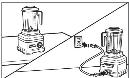
**1** Avant d'utiliser le mélangeur, s'assurer que le comptoir situé sous et près du mélangeur est sec et propre. Vérifier que le commutateur d'alimentation situé derrière la base du mélangeur est fermé (**O**) et que le cordon est bien branché au dos du mélangeur. Brancher ensuite le mélangeur sur une prise à 3 alvéoles reliée à la terre.
