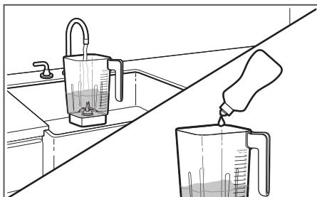
**2** Asegúrese de limpiar la jarra de la licuadora, la tapa y la tapa para ingredientes después de cada uso. Retire todo contenido restante de la jarra de la licuadora. Llene la jarra de la licuadora con 2 tazas de agua tibia y 1 gota de detergente líquido. Coloque la tapa en la jarra de la licuadora y asegúrese de que la jarra esté completamente en su lugar sobre la base.
