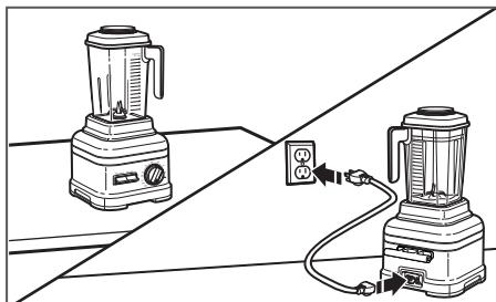
**1** Antes de usar la licuadora, asegúrese de que el mostrador debajo del aparato y las áreas circundantes estén secos y limpios. Asegúrese de que el botón **I/O** (Encendido/Apagado) en la parte posterior de la base de la licuadora esté en la posición **O** (Apagado) y que el cable también esté totalmente enchufado en la parte posterior de la licuadora. Después, enchufe la licuadora en un tomacorriente de 3 terminales con descarga a tierra.
