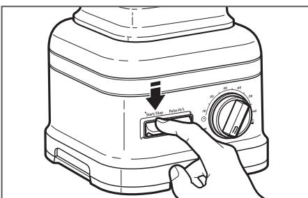
7 Después de licuar, mueva el interruptor alternador START/STOP (Endendido/Apagado) hacia arriba o hacia abajo. Espere hasta que la licuadora se detenga por completo antes de retirar la tapa y volcar los ingredientes licuados.
