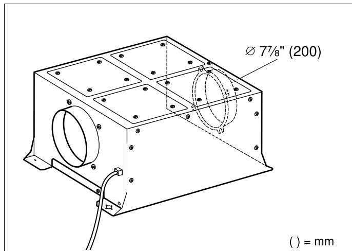
Cotes de l'appareil pour l'installation au mur
