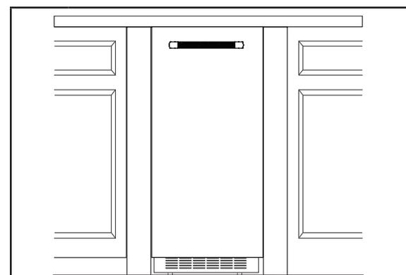
**4** Coller le panneau personnalisé sur la porte en utilisant des morceaux d'adhésifs recto verso et en poussant doucement. Ajuster la hauteur du panneau pour l'aligner avec les armoires. Appuyer fermement le panneau contre la porte.
