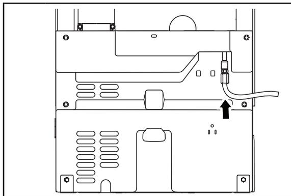
**6** Insérer en ligne droite l'extrémité du tuyau aussi profondément que possible dans l'extrémité de sortie. Visser l'écrou de compression sur l'extrémité de sortie du raccord à l'aide d'une clé à molette. Serrer l'écrou manuellement. Ensuite, serrer deux tours de plus avec une clé. Ne pas serrer excessivement.
