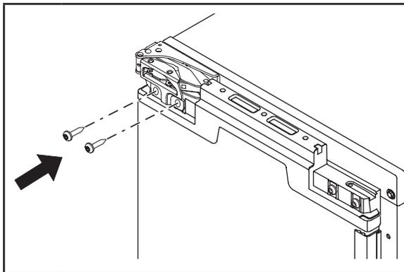
**6** Glisser la porte sur les charnières. À l'aide d'un tournevis Torx T25, placer les vis (retirées à l'étape 6 de la section "Retirer les charnières") sur la porte.
