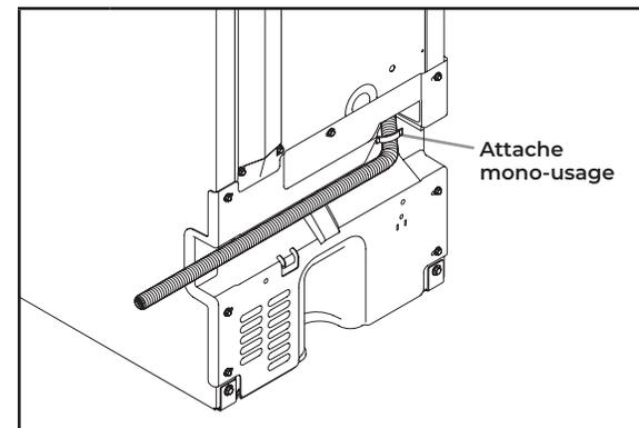
**15** À l'aide d'une attache mono-usage, fixer le tube de vidange au panneau arrière comme illustré.
