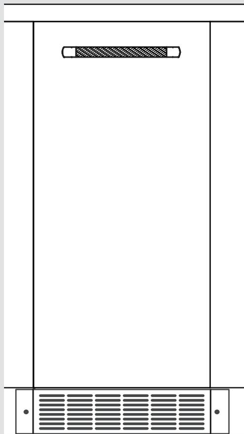
La grille auxiliaire est un accessoire optionnel. Elle peut être utilisée pour aligner la grille inférieure avec le reste des armoires sans bloquer la ventilation de la machine à glaçons.
