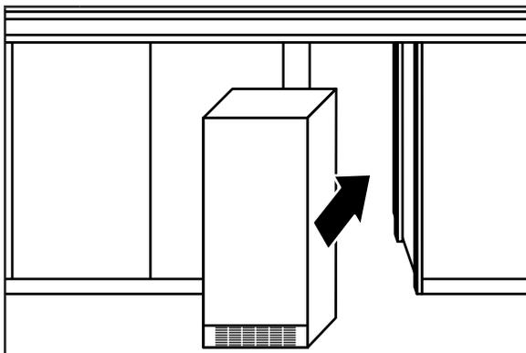
**6** Glisser la machine à glaçons dans l'armoire tout en faisant attention aux positions des connexions à l'arrière de la machine à glaçons. Pour éviter d'endommager le plancher, bien le recouvrir de carton ou de contreplaqué.
