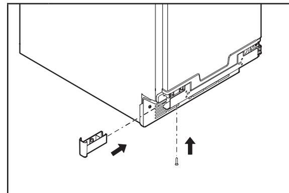
**7** Replacer les embouts du haut et du bas dans la porte. Fixer l'embout du bas à l'aide de la vis en passant par le trou de la bride en métal du bas.
