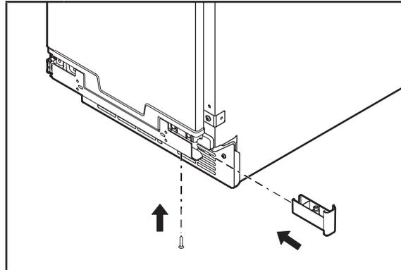
**7** Réinstaller les embouts du haut et du bas sur la porte (le capuchon supérieur de droite est maintenant dans la position inférieure gauche et vice-versa).
