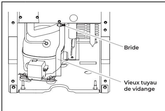
**2** Enlever le vieux tube de vidange et la bride fixée au bac de la machine à glaçons.
