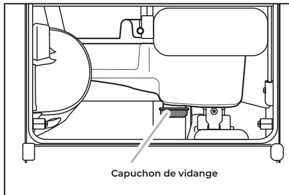
**4** Dévisser le bouchon de vidange du dessous du bac à eau situé à l'intérieur du bac d'entreposage. Laisser l'eau s'écouler entièrement.
