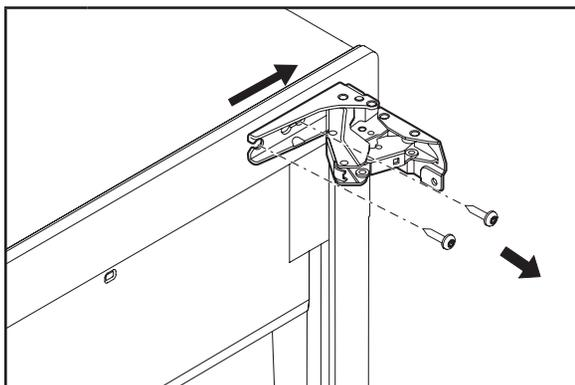
**7** Retirer les vis et charnières du cabinet en utilisant un tournevis Torx T25 et les mettre de côté pour plus tard.
