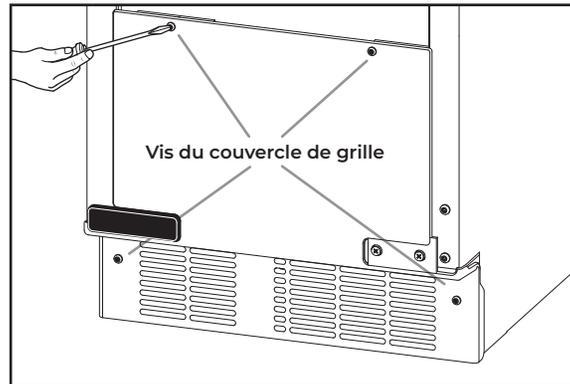
**1** Dévisser et enlever le couvercle de grille en utilisant un tournevis TORX T20. Les garder de côté.
