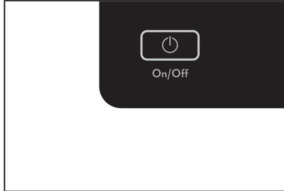
**3** Mettre la machine à glaçons en marche. Attendre que le programme de rinçage se déclenche (environ 5 minutes) pour s'assurer que la machine à glaçons fonctionne correctement.
