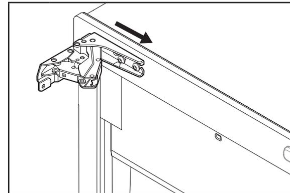
**3** Prendre la charnière inférieure d'origine, la faire pivoter et la placer à la position de la charnière supérieure du côté opposé. La glisser sur les vis de charnière.
