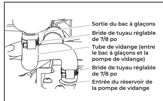
**11** Un nouveau tube de vidange est fourni avec la pompe de vidange. Installer le nouveau tube de vidange entre la sortie du bac à glaçons et l'entrée du réservoir de la pompe de vidange en utilisant les nouvelles brides ajustables.
