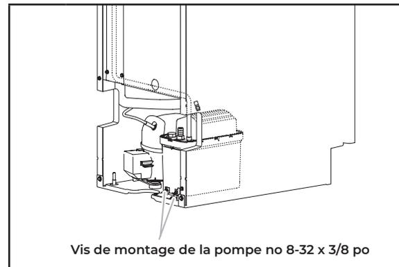
**4** Aligner les deux trous de vis situés à l'arrière de la pompe. Utiliser deux vis no 8-32 x 3/8 po incluses pour fixer la pompe à la base de la machine à glaçons.
