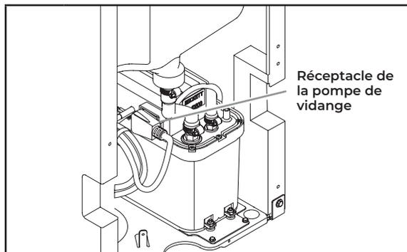
**9** Enrouler le cordon d'alimentation de la machine à glaçons pour créer un rouleau de 4 po (10,2 cm). Fixer le cordon enroulé à l'aide de ruban électrique ou d'une attache mono-usage. Placer le cordon d'alimentation comme indiqué dans l'illustration et le brancher dans la prise de la pompe de vidange.
