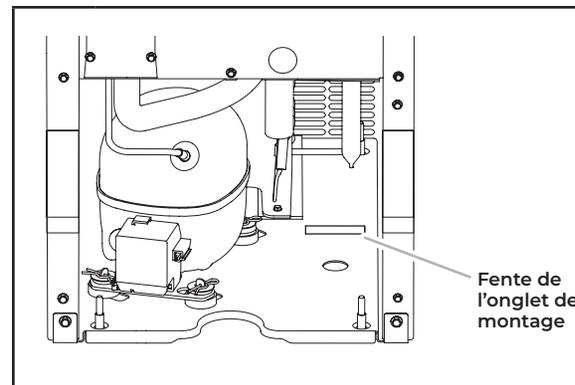
**3** Installer la pompe de vidange sur le côté droit de la base de la machine à glaçons. Incliner légèrement la pompe de vidange pour faire glisser l'onglet de montage dans la fente de l'onglet de montage.
