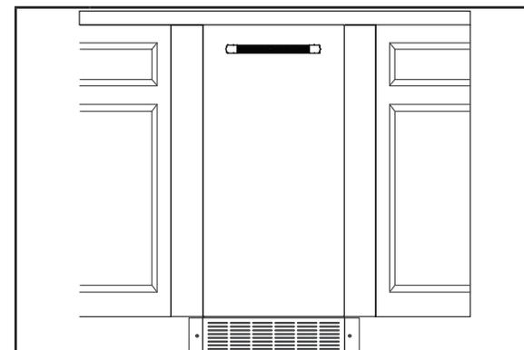
**6** À l'aide d'un tournevis TORX T20, visser la grille auxiliaire aux armoires.
