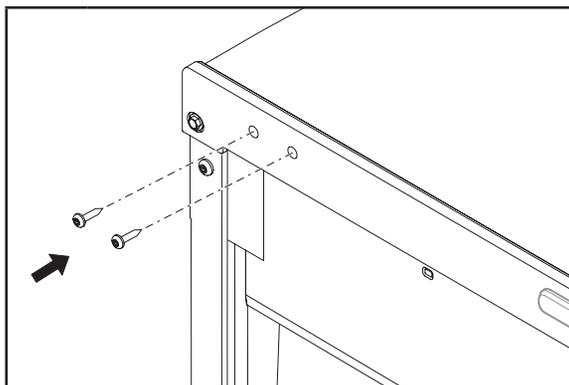
**1** Visser à moitié les vis de charnières (mises de côté à l'étape 7 du point "Préparer les charnières du bas") sur le côté désiré.
