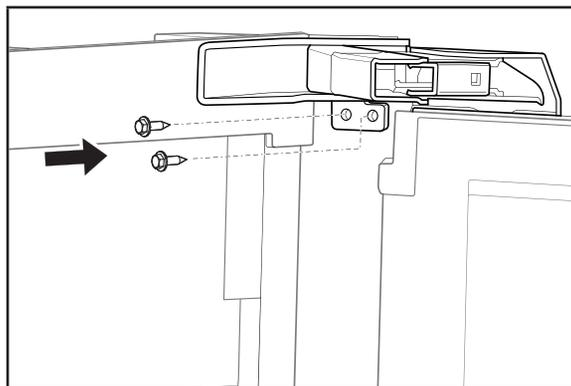
**7** S'assurer que la machine à glaçon est à la bonne profondeur. Fixer les charnières du haut et du bas sur le côté de l'armoire en utilisant des vis à bois.
