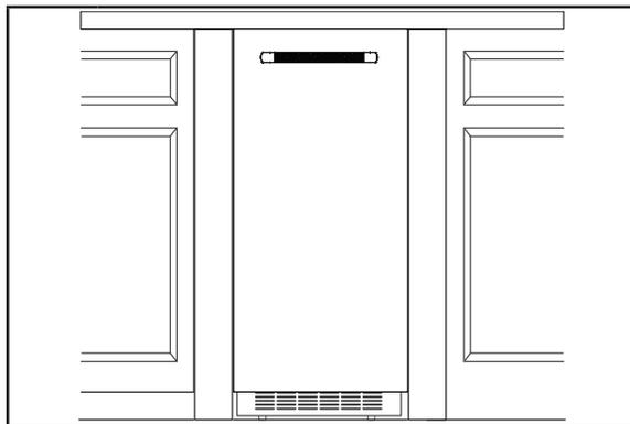
**6** Effectuer l'ajustement gauche-droite du panneau pour obtenir l'espace désiré de chaque côté. Installer les vis restantes sur le panneau de porte en passant par les supports.
