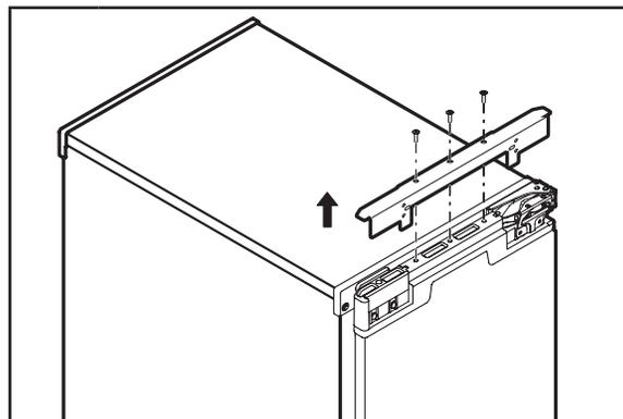
**1** Retirer les vis et la bride métallique du haut en utilisant un tournevis cruciforme. Les retirer et les conserver pour plus tard. Passer cette étape et poursuivre avec l'étape 4 si l'inversion de la porte a été effectuée.
