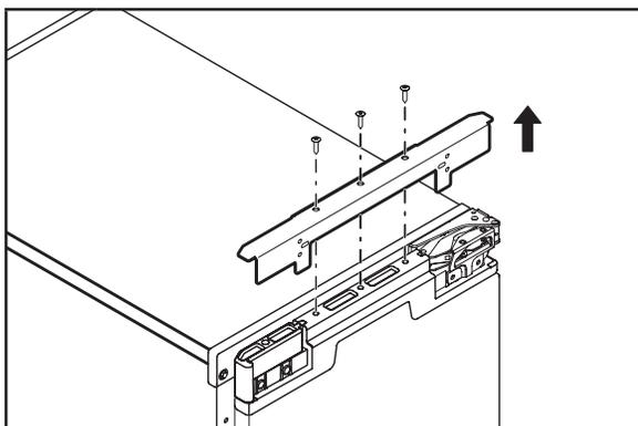
**2** Retirer les vis et la bride métallique du haut en utilisant un tournevis cruciforme. Les garder de côté.
