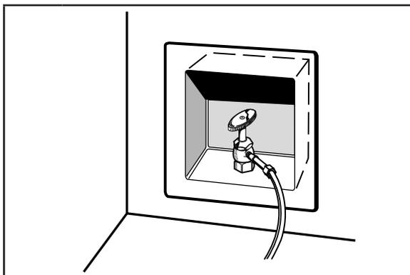
**2** Fermer l'alimentation en eau. Attendre de 5 à 10 minutes que les glaçons tombent dans le bac d'entreposage. Enlever les glaçons du bac d'entreposage.
