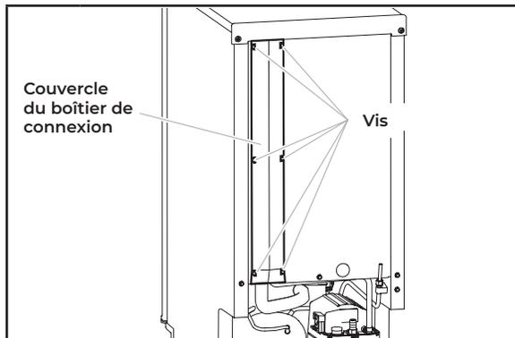
**5** Dévisser les vis fixant le couvercle du boîtier de connexion à la machine à glaçons et enlever le couvercle du boîtier de connexion. Placer les vis et le couvercle du boîtier de connexion à part.
