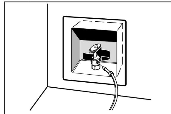
**7** Ouvrir le robinet d'arrêt. Vérifier qu'il n'y a pas de fuite. Serrer tous les raccords (y compris les raccords du robinet) ou les écrous qui présentent des fuites.
