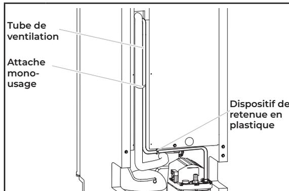
**7** Placer le tube de ventilation dans le dispositif de retenue en plastique comme indiqué dans l'illustration. À l'aide d'une attache mono-usage, fixer le tube de ventilation au dos du tube d'aération et des câbles situés derrière le couvercle du boîtier de connexion. Réinstaller le couvercle du boîtier de connexion et les vis.
