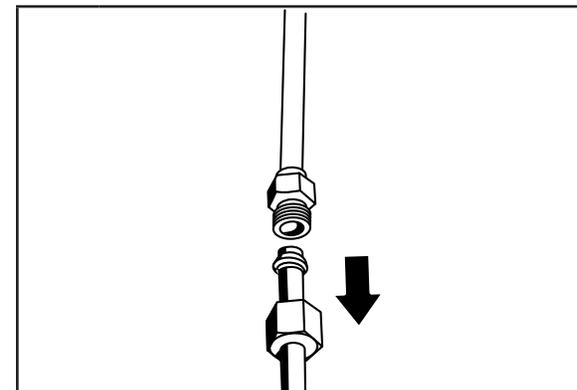
**5** Débrancher la canalisation d'alimentation en eau.
