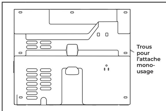
**13** Installer l'attache mono-usage sur le panneau arrière en la passant par les deux trous situés sur le panneau arrière.
