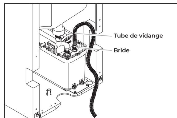
**12** Fixer le tube de vidange au tube de vidange de la pompe en utilisant la bride fournie.
