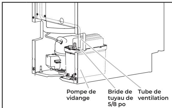
**6** Installer le tube de ventilation (5/16 po de diamètre intérieur x 32 po [81 cm]) à la ventilation du réservoir de la pompe de vidange. Utiliser l'une des petites brides réglables incluses de 5/8 po.
