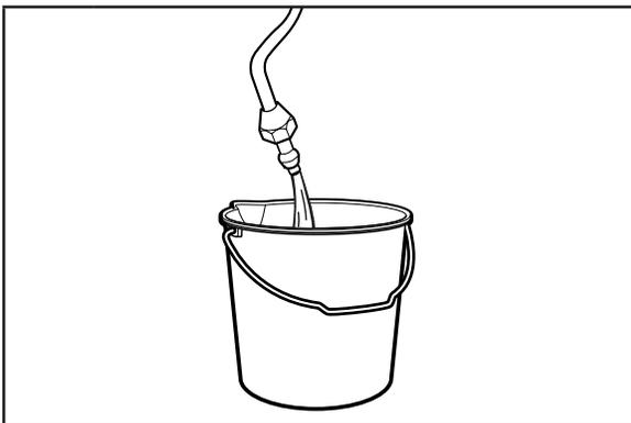
**4** Vidanger le tuyau en plaçant l'extrémité libre dans un contenant ou un évier et en rétablissant l'alimentation principale en eau jusqu'à ce que l'eau sorte propre. Fermer le robinet d'arrêt sur le tuyau d'alimentation en eau.
