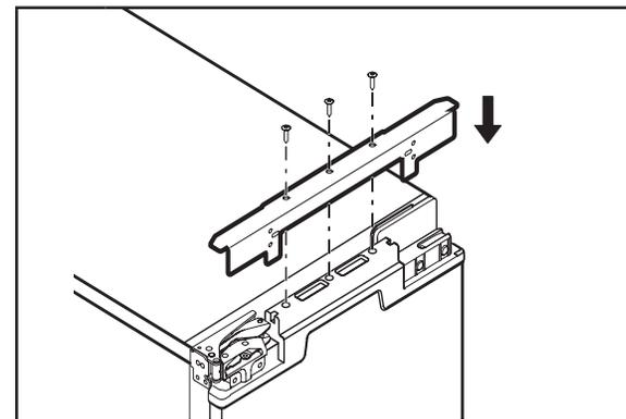
**3** Replacer le support de métal du haut en utilisant les vis retirées à l'étape 1.
