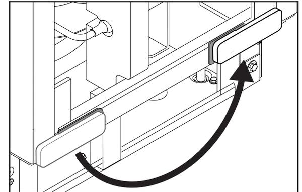
**2** Retirer le capuchon de vis et le placer de l'autre côté comme indiqué dans l'illustration.
