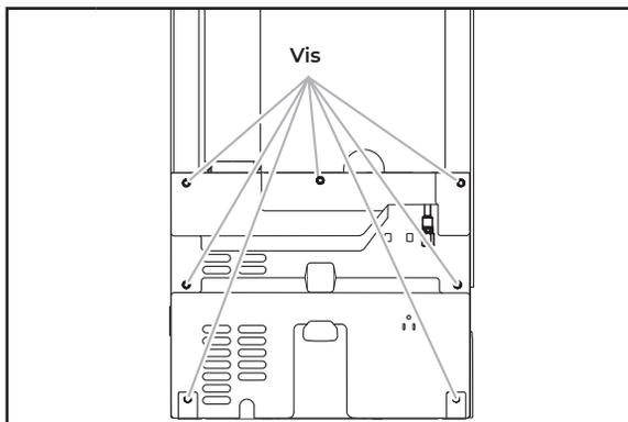
**1** Dévisser les vis fixant le panneau arrière à la machine à glaçons. Retirer les vis et le panneau arrière, puis les mettre de côté. Pour les modèles avec pompe, passer à l'étape 12.
