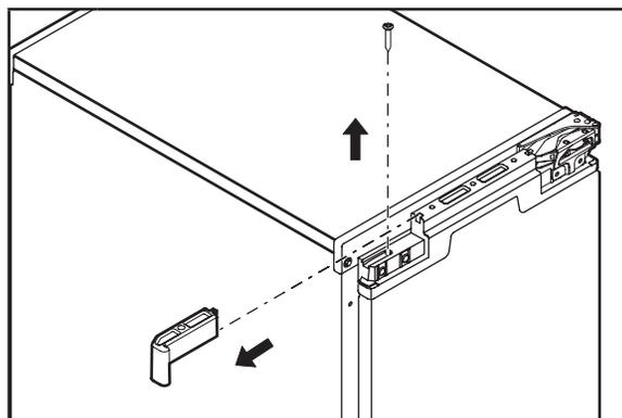
**3** Retirer les vis des embouts du haut et du bas en utilisant un tournevis cruciforme. Les retirer et les conserver pour plus tard.
