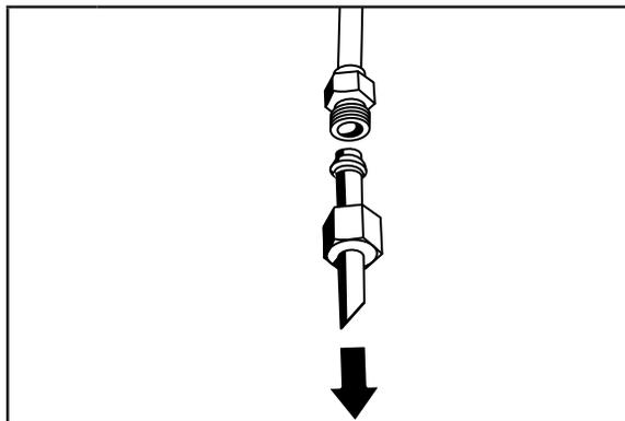
**5** Retirer et jeter le petit tube de plastique de l'extrémité du point d'entrée de la canalisation d'eau.
