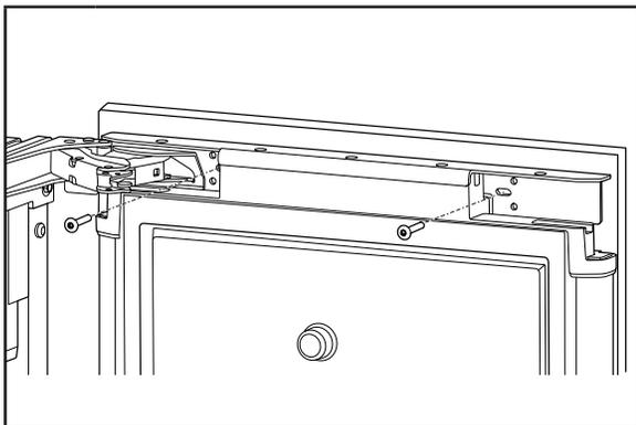
**5** À partir de l'intérieur de la porte, installer les vis à bois dans les fentes du support en métal.
