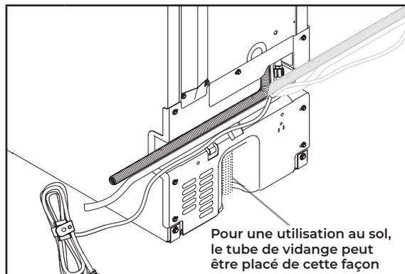
**14** Acheminer le tube de vidange, le cordon d'alimentation et le tuyau d'alimentation en eau de la pompe de vidange par la fente du panneau arrière de la machine à glaçons. Réinstaller le panneau arrière et les vis.
