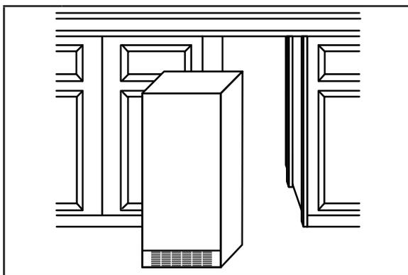
**3** Si la machine à glaçons est installée dans une armoire, la retirer de l'ouverture.
