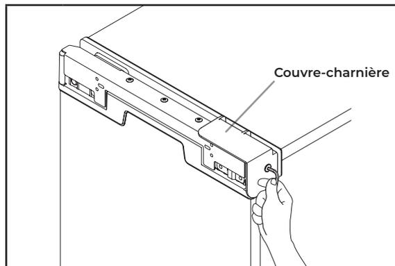
**2** Retirer les vis fixant le dessus et le dessous des couvre-charnières en utilisant un tourne-écrou de 3/16 po.
