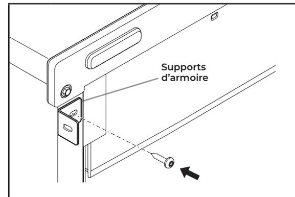
**8** Fixer les supports d'armoire (inclus avec la machine à glaçons) aux trous à l'avant de la machine à glaçons comme illustré. Fixer les charnières d'armoire sur le côté de l'armoire en utilisant des vis à bois.
