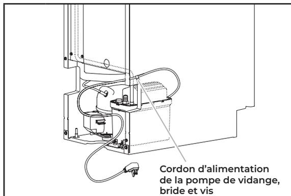
**10** Fixer le cordon d'alimentation de la pompe de vidange sur la paroi latérale de la machine à glaçons en utilisant la bride et la vis (enlevées à l'étape 7).
