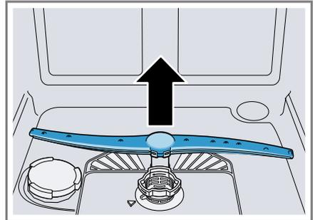
3. Sous l'eau courante, s'assurer que les buses de sortie des bras d'aspersion sont dégagées et éliminer les corps étrangers au besoin.
