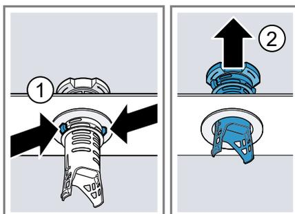
5. Passer les éléments filtrants sous l'eau courante pour les nettoyer.
