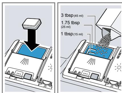
Si des pastilles sont utilisées, une seule suffit. Disposer la pastille horizontalement.
