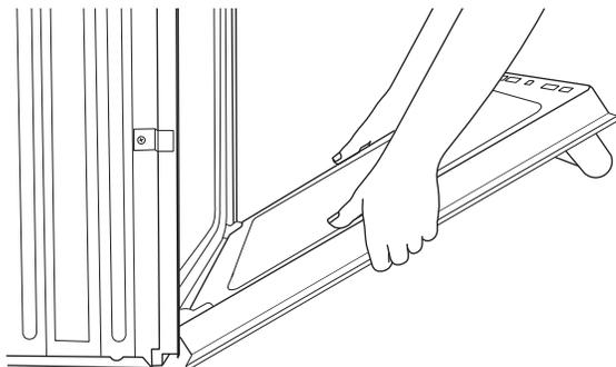
5. Saisir les bords de la porte du four avec les deux mains. Soulever et tirer la porte du four vers soi et enlever la porte. Vous devrez peut-être basculer doucement la porte d'un côté et de l'autre en la tirant.
