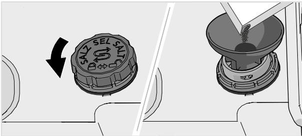
1. Retirez le couvercle du compartiment à sel en le tournant dans le sens inverse des aiguilles d'une montre.
