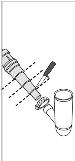
Le tuyau d'évacuation peut aussi être raccordé à un embout sur le siphon de l'évier. L'embout doit avoir un diamètre interne d'au moins 1/2" (14 mm).
