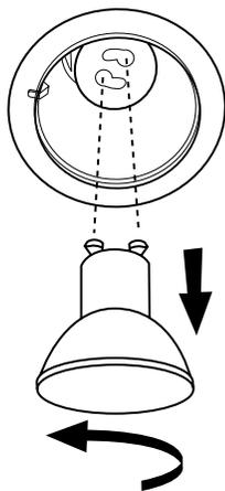
3. Retirer l'ampoule et la remplacer par une ampoule DEL de 120 volts, 6,5 watts maximum avec culot GU10. La tourner dans le sens horaire pour l'emboîter.
