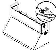
5. Introduzca 2 tornillos de 4,2 x 8 mm desde el interior de la campana extractora para fijar la tapa del conducto a la campana. Vea la imagen de abajo.
