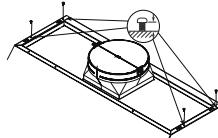
3. Placez le couvercle du conduit sur le dessus de la hotte et insérez la tête des vis précédemment montées sur les trous d'installation du couvercle du conduit.
