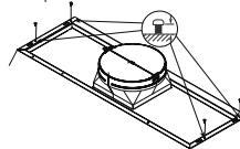
3. Coloque la cubierta del conducto sobre la parte superior de la campana e introduzca la cabeza de los tornillos previamente montados en los orificios de instalación de la cubierta del conducto.
