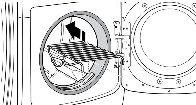
2. Aligner les deux crochets situés à l'avant de la grille de séchage avec les trous situés dans l'ouverture de la porte de la sècheuse et les insérer complètement dans les trous en appuyant. Placer le support arrière sur le rebord arrière de la sècheuse.
