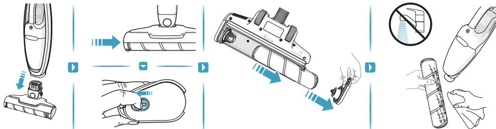
**\* Pet Nozzle Maintenance / Entretien de la buse Pet / Mantenimiento de la boquilla Pet**
