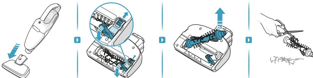
**Replacing Battery Pack / Remplacement du bloc-pile / Reemplazo del paquete de baterías**
