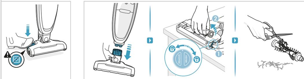
**\* PowerPro Nozzle Maintenance / Entretien de la buse PowerPro / Mantenimiento de la boquilla PowerPro**
