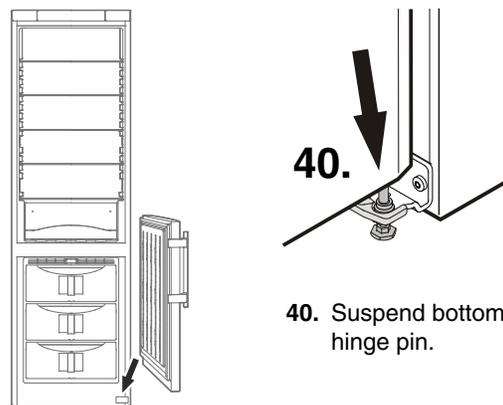
**40.** Suspend bottom door on hinge pin.
