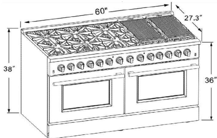
Cette cuisinière peut être installée directement à côté des armoires existantes à une hauteur de comptoir (36 po ou 91,5 cm du sol). Pour obtenir le meilleur aspect possible, la table de cuisson doit être au même niveau que le comptoir de l'armoire. Cela peut être obtenu en soulevant l'unité à l'aide des tiges de réglage sur les pieds.
