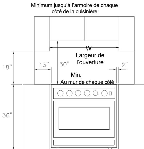
Profondeur maximale des armoires au-dessus des comptoirs
