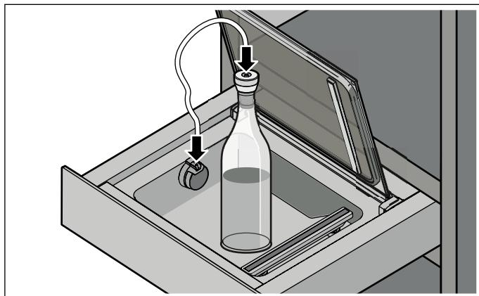
3. Fixez le tuyau sur l'adaptateur de vide et l'adaptateur de bouteille.
