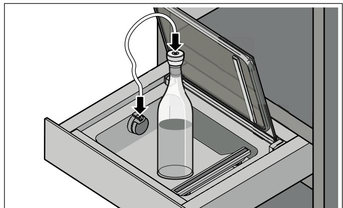
3. Fijar el tubo al adaptador de vacío y al adaptador de botella.
