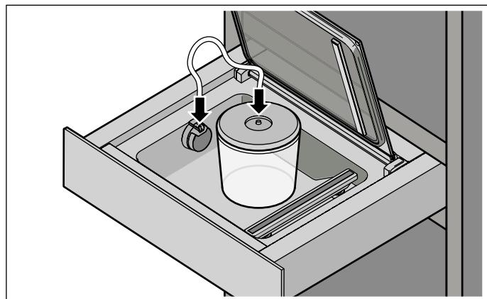
2. Conectar el adaptador de envasado al vacío a la salida de aire.
