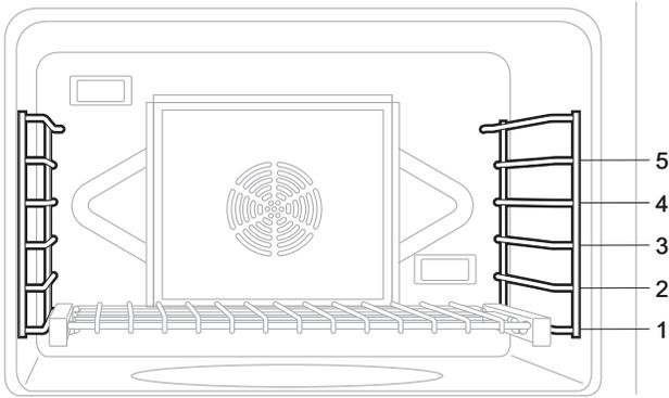
Figure 1 : Positions des grilles dans le grand four
