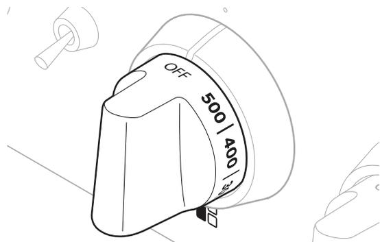
Figure 24 : Bouton de commande de la plaque chauffante
