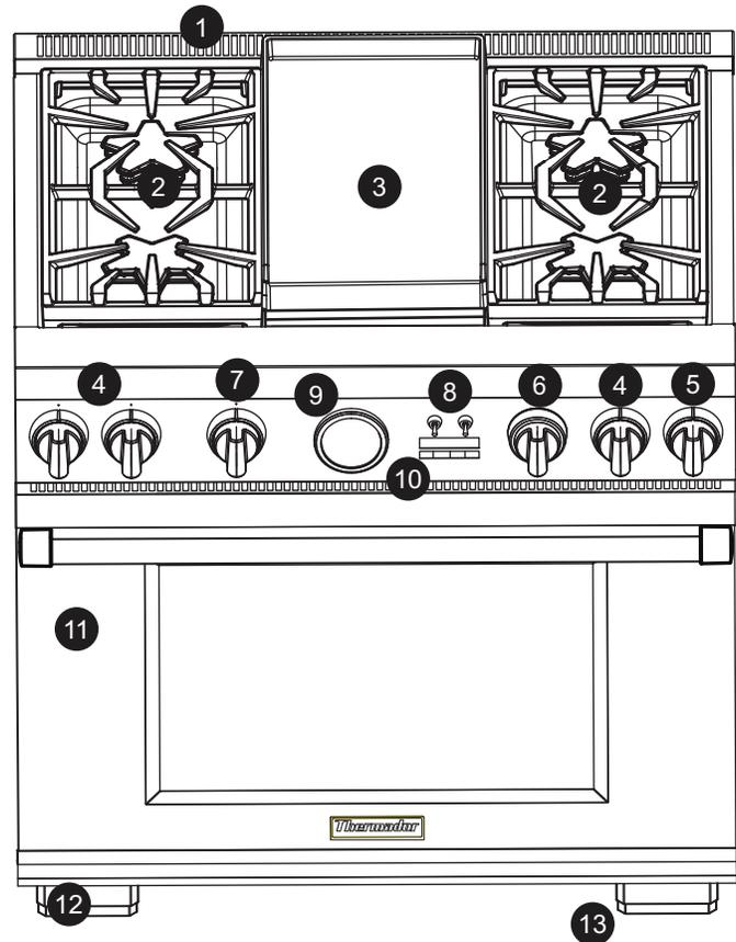
Figure 6 : Identification des pièces de la cuisinière à gaz de 36 po
