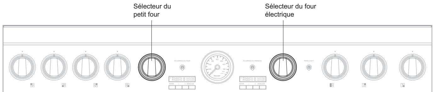
Figure 31 : Tableau de commande du modèle de 48 po
