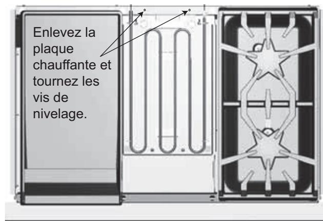
Figure 25 : Vis de nivelage de la plaque chauffante
