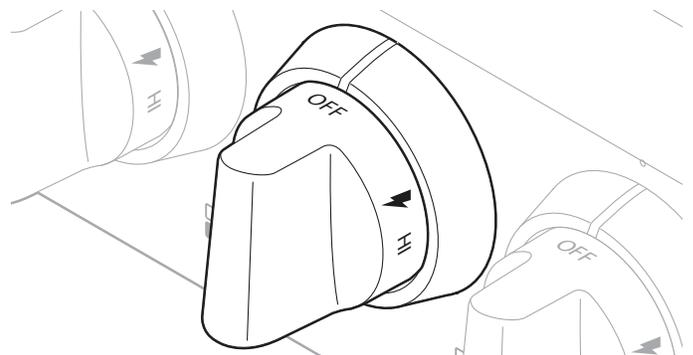
Figure 10 : Bouton de commande standard d'un brûleur
