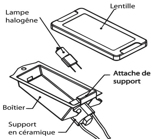
Figure 33 : Assemblage de la lampe du four
