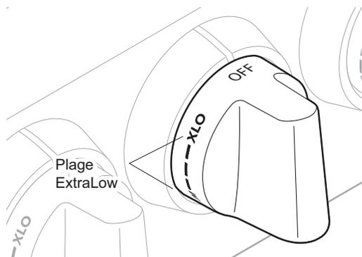
Figure 12 : Bouton de commande d'un brûleur ExtraLow
