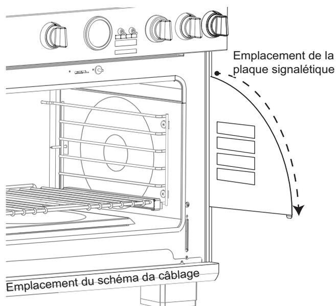
Figure 35 : Emplacement de la plaque signalétique
