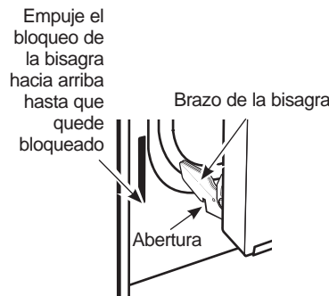
Empuje los bloqueos de las bisagras hacia arriba para desbloquearlos
