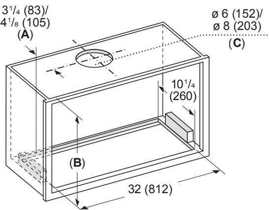
**A:** Emplacement de l'ouverture du conduit (à partir du bord intérieur arrière de l'armoire)
